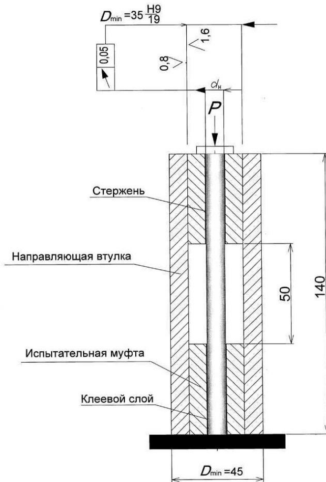
Рисунок Г.2 – Приспособление для испытания образцов на сжатие
